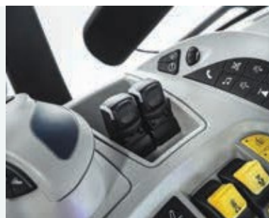
Опционален хидравличен дистанционен панел с 2 лоста
