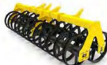
Ролка с двойна U-образна пръстенна конструкция
